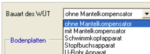
Die Beanspruchung der Rohre infolge Wärmedehnung und Querkontraktion sowie die Rohrkraft durch äußere Kräfte werden durch die Bauart des Rohrbündel-Wärmeübertragers bestimmt.
